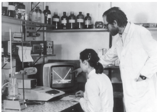
Slika 1 – Prva automatska potenciometrijska kiselinsko-bazna titracija koloidne suspenzije u Zavodu za fizikalnu kemiju, Kemijski odsjek, PMF (oko 1985.)
