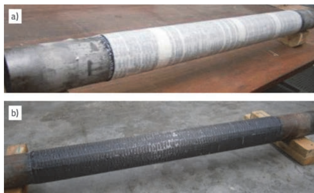
Slika 7. Njegovanje uzoraka na sobnoj temperaturi: a) uzorak sa samoljepivom vrpcom; b) uzorak nakon skidanja samoljepive vrpce
