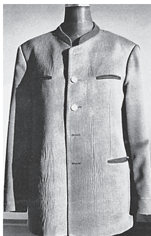
Sl.7 Loš izgled odjavnog predmeta nakon kemijskog čišćenja zbog različitog skupljanja frontalno fiksirane međupodstave i osnovne tkanine [11]
