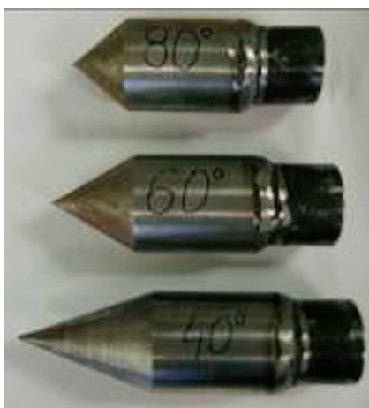
Figure 3 Cone specimens Slika 3. Uzorci klina
