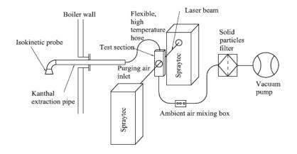
**Figure 3.** Scheme of the extraction line forparticles sampling from the combustion chamber **Slika 3.** Shema linije za ekstrakciju uzoraka čestica iz komore za izgaranje
