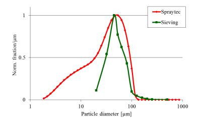
**Figure 4.** Size distribution functions yield by the Spraytec and sieving analysis **Slika 4.** Funkcije raspodjele veličine čestica pomoću Spraytec i analize prosijavanjem
