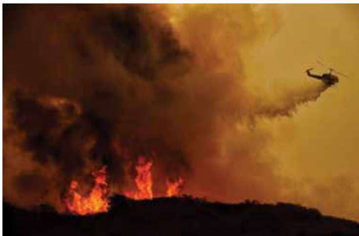
Slika 1. Primjer gašenja požara otvorenog ravnog područja helikopterom – taktika gašenja podrazumijeva izbjegavanje ulaznja helikoptera u atmosferu iznad požara
