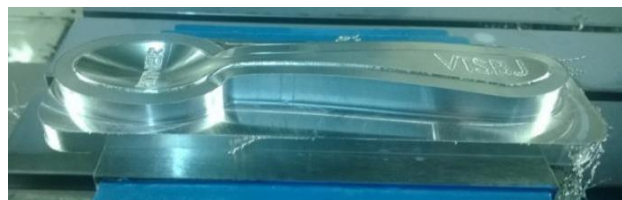
Slika 16. Prikaz gotove operacije 3D glodanja konture žiga
