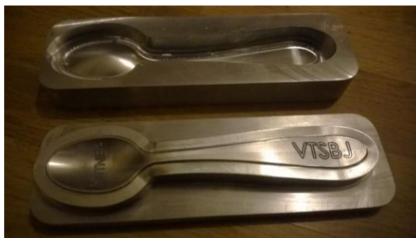
Slika 20. Prikaz gotovog žiga i matrice
