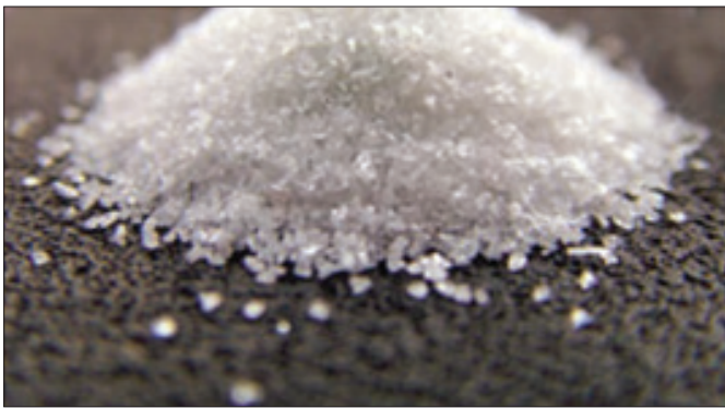
S l i k a 1 – Korund s više od 98 % \text{Al}_2\text{O}_3
