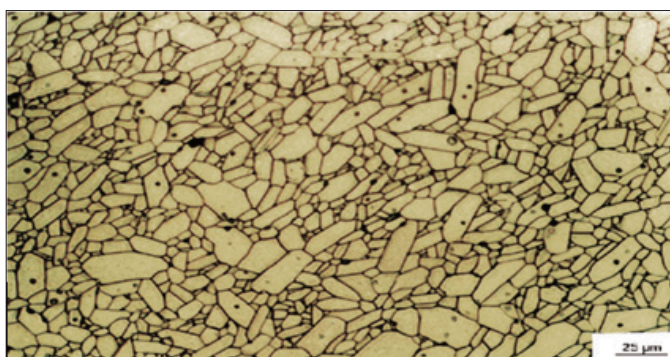
Slika 2 – Mikrostruktura sinterirane aluminij-oksidge keramike Fig. 2 – Microstructure of sintered aluminum oxide ceramic
