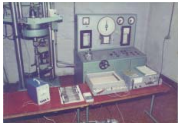
Figure 6. Ductility examination by torsion method Slika 6. Oprema za ispitivanje duktilnosti pomoću torzije
