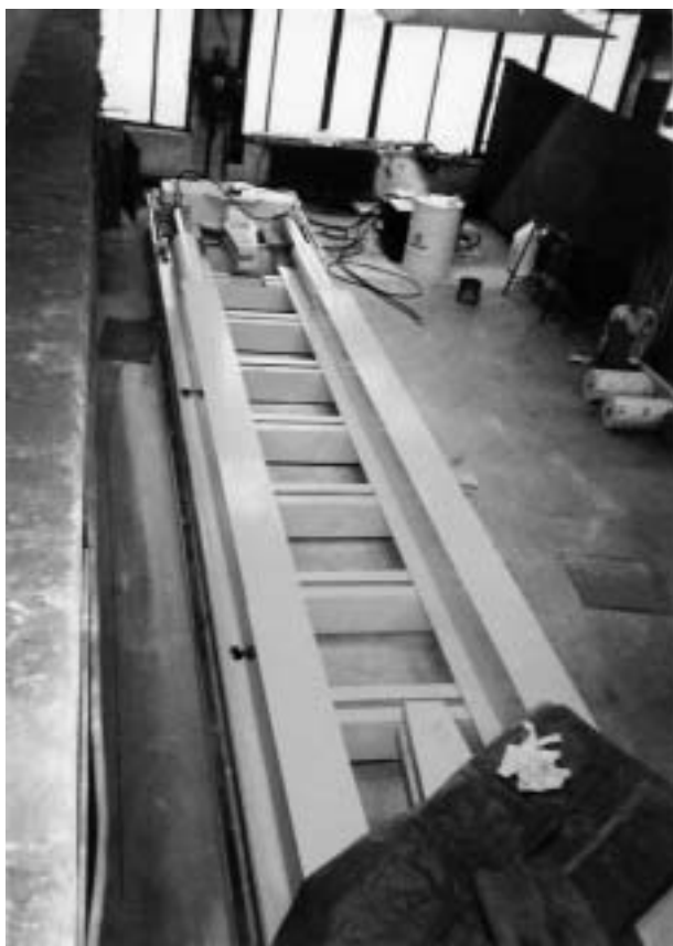
Figure 1. Bearing structure of the tear off machine KREPET-BME 2500/SKTC147 Slika 1. Izvlačna konstrukcija stroja KREPET-BME 2500/SKTC 147
