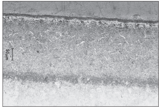
Figure 4 Steel 100Cr6 nitrided layer (D)
