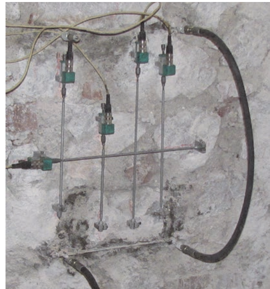
Slika 6. Postav ispitivanja pomoću dvostrukog tlačnog jastuka
