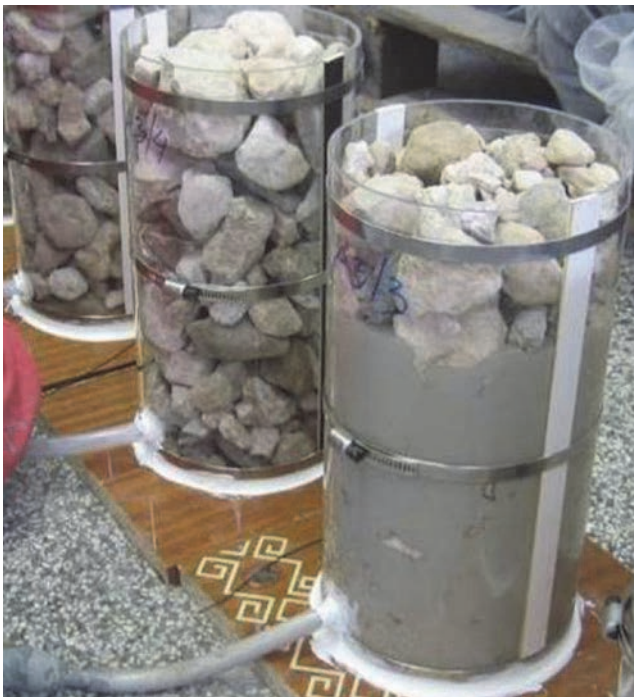
Slika 3. Valjkasti uzorci tijekom injektiranja
