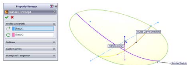
Slika 2. Zaobljenje površine ( Surface Swept )
