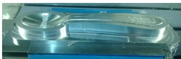
Slika 16. Prikaz gotove operacije 3D glodanja konture žiga
