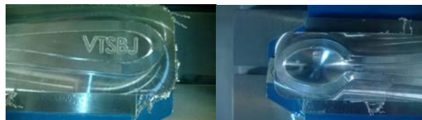
Slika 15. Prikaz gotove operacije 3D graviranja žiga
