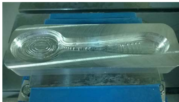
Slika 18. Prikaz gotove operacije 3D glodanja konture matrice
