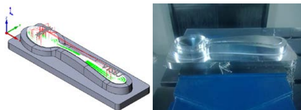
Slika 14. Prikaz simulacije i gotove operacije 3D glodanja površine žiga na mjestu gdje dolazi žlica
