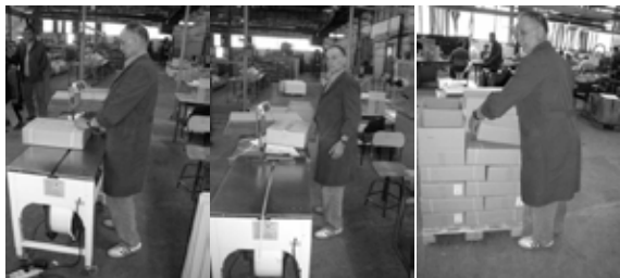
Slika 2. Uvezivanje, vaganje i slaganje kutija na europaletu
