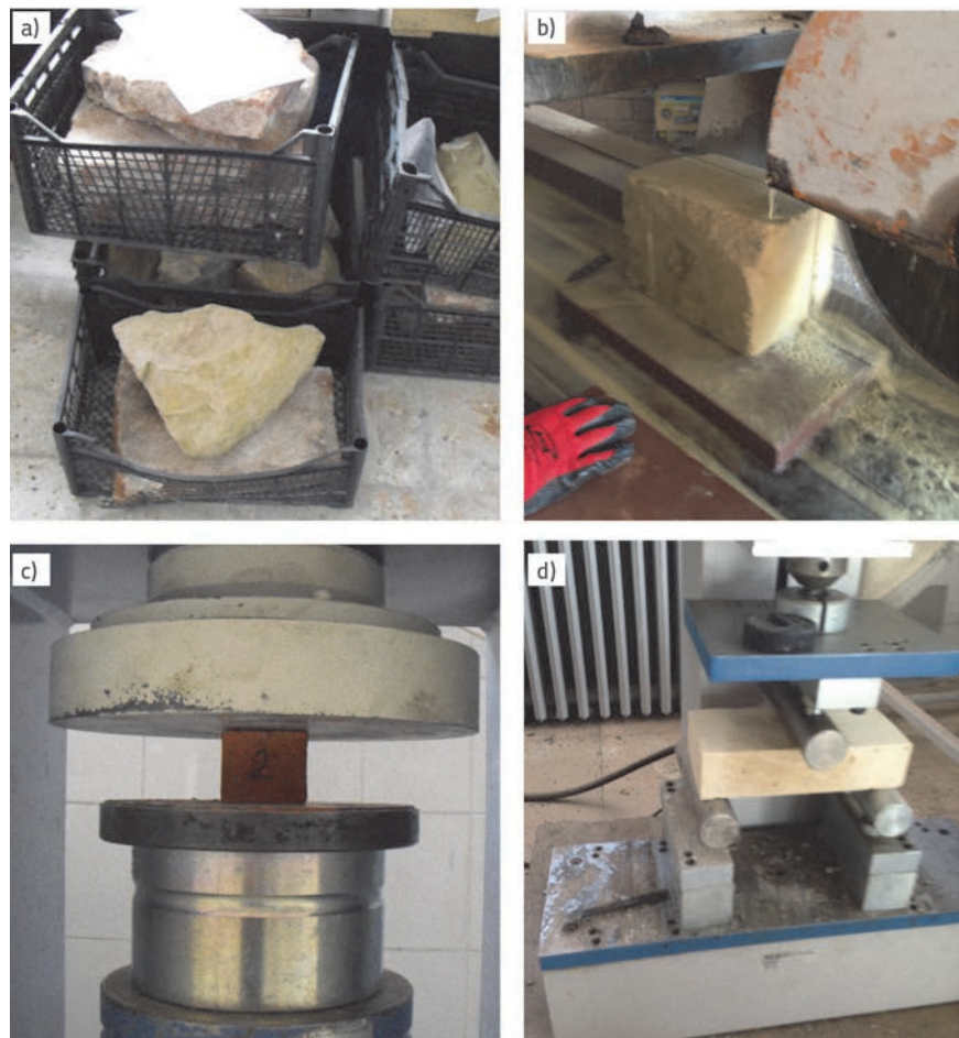
Slika 8. Priprema i ispitivanja uzoraka: a) prikupljeni materijal, b) pripremanje uzoraka c) ispitivanje tlačne čvrstoće, d) ispitivanje savijanja u tri točke
