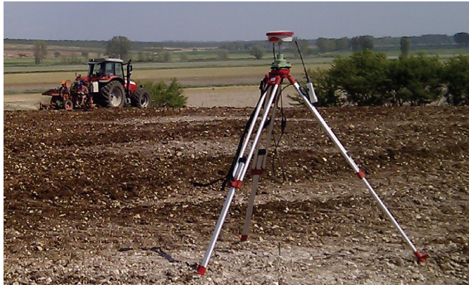
Slika 1. Prikaz laserskog i GPS sustava održavanja pravca
