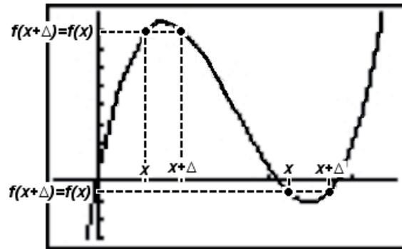
Figura 1.18 Ilustración del método de Fermat,  $\Delta > 0$
