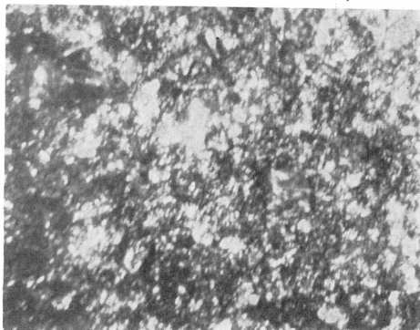
Slika 3. Površina Co, Cr, Mo legure neposredno posle livenja i peskiranja. X 80.
