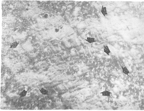
Slika 10. Površina Co, Cr, Mo legure elektrohemijski loše polirana pri naponu strujnog kola od 20 V. Bele tačkaste površine (označene strelicama) predstavljaju elektrohemijski nagrižene površine. X 80.
