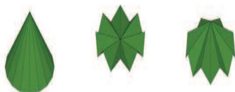
Figura 4: Los tres tipos de vértices: convexo apropiado, silla de montar apropiado y , combinada
