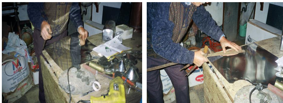
Figura 4. Latoeiro a trabalhar uma folha de Flandres
