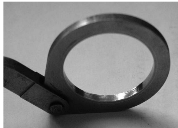
Figure 12. Appearance of worn coulissee Slika 12. Izgled istrošenog vanjskog prstena
