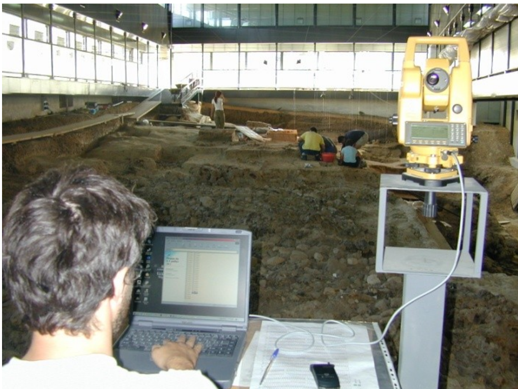
Fig. 48 - Isernia La Pineta. L'utilizzo della stazione totale, modello GTS-605 (foto G. Lembo).
