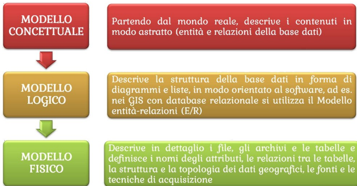
Fig. 4 - Schema riassuntivo dei livelli di modellizzazione nella costruzione di una banca dati (da Peuquet, 1984).
