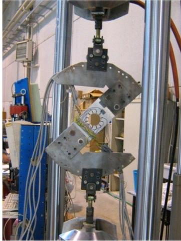
*Fig. 5.3.1: particolare sistema di afferraggio per i provini.*
