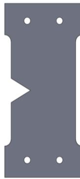
*Fig 5.4.1 geometria del provino*
