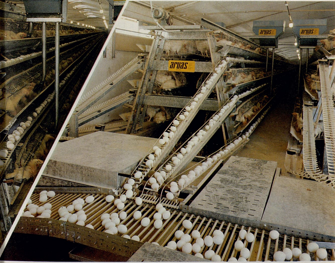
Transportador general de huevos hecho en nylon y fibra de vidrio. Ideal para el transporte desde las baterías al centro de envasado. Cucharillas de plástico insertadas en cadenas, hacen una superficie ideal para transportar y cambiar de nivel los huevos hasta su destino.
