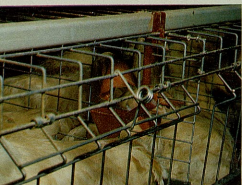
Bebedero de copa muy eficiente, autolimpiante. Todo el frente es puerta, que facilita el manejo de aves.
