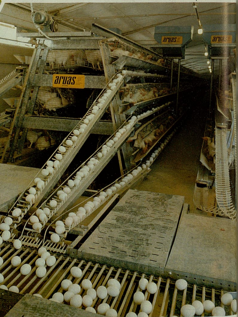
Transportador general de huevos hecho en nylon y fibra de vidrio. Ideal para el transporte desde las baterías al centro de envasado. Cucharillas de plástico insertadas en cadenas, hacen una superficie ideal para transportar y cambiar de nivel los huevos hasta su destino.
