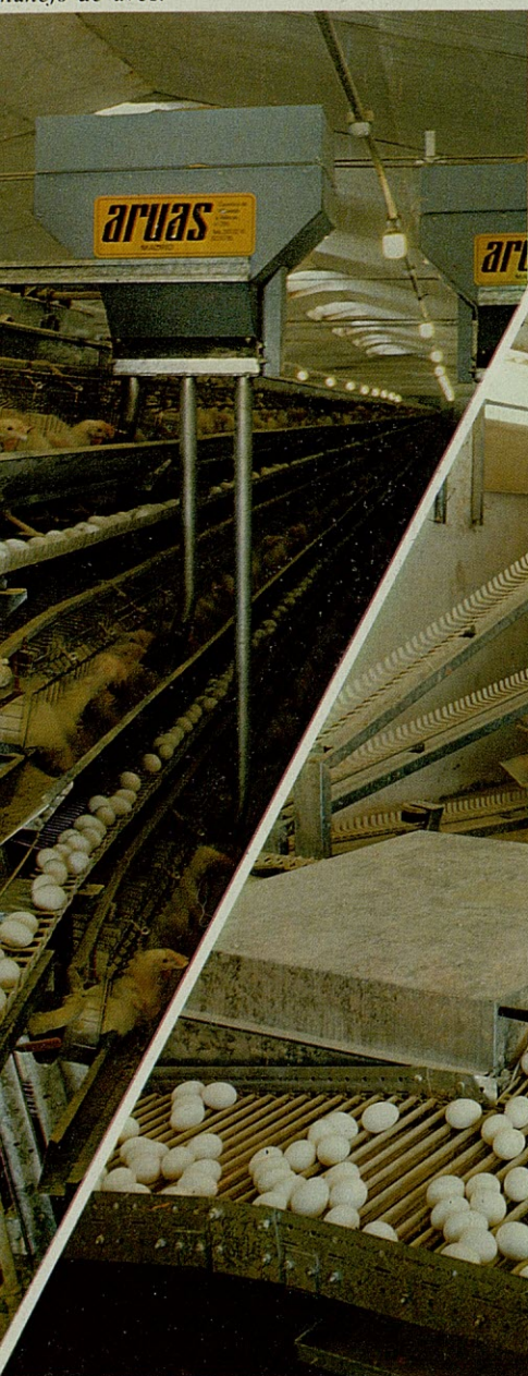
Transportador general de huevos hecho en nylon y fibra de vidrio. Ideal para el transporte desde las baterías al centro de envasado. Cucharillas de plástico insertadas en cadenas, hacen una superficie ideal para transportar y cambiar de nivel los huevos hasta su destino.
