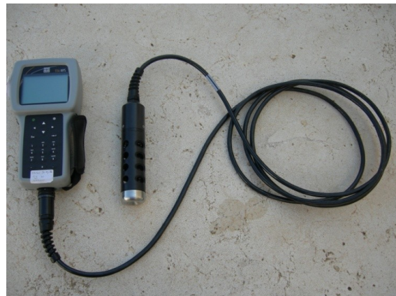
Figura 13: Sonda YSI 556 MPS per la lettura di pH, T, O 2 disciolto
