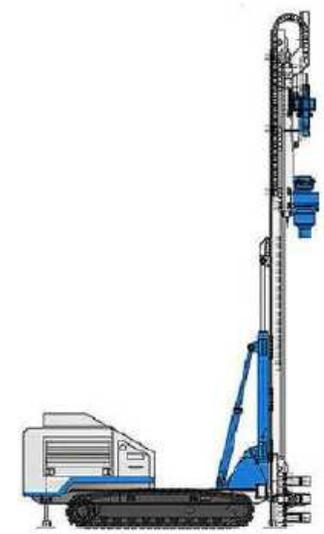
Perforazione con doppia testa di rotazione a circolazione diretta di fluidi di perforazione.
