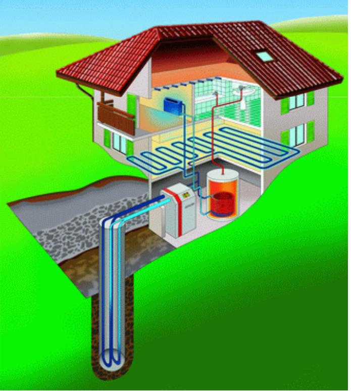
**In estate** il calore in eccesso presente nella casa viene eliminato trasportandolo nel sottosuolo attraverso lo scambiatore di calore.
