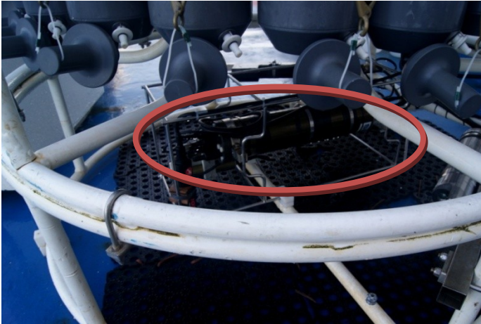
Fig. 2: A) Dettaglio della sonda multiparametrica CTD.
