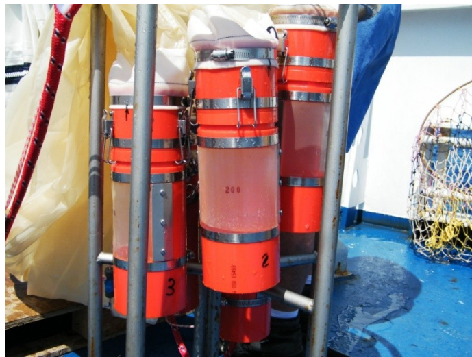
Fig. 14: Particolare dei 5 bicchieri di raccolta campione MPS
