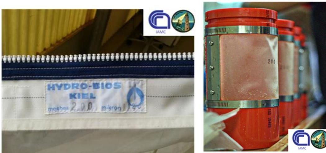
Figura 4: A - Multi Plankton Sampler - particolare chiusura lampo e grandezza maglia; B - Collettori.
