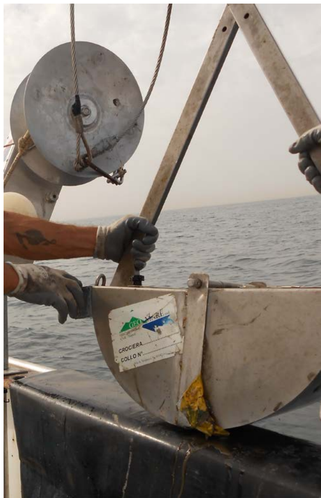
Figura 7.4 Benna Van Veen montata sul natante
