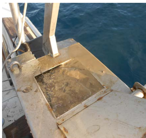
Figura 7.5a-b Fasi di prelievo del sedimento con benna
