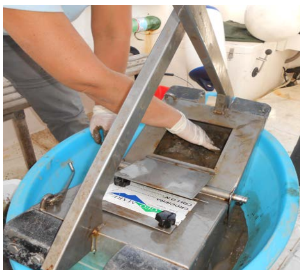
Figura 7.5a-b Fasi di prelievo del sedimento con benna
