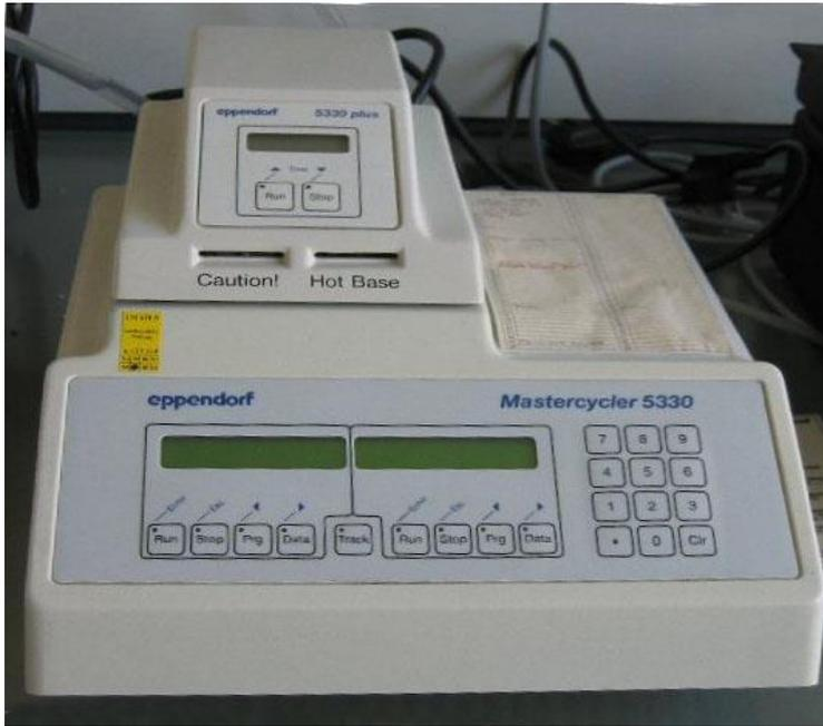
**Figura 7a:** Strumento programmabile e autoriscaldante, in cui è possibile settare le varie fasi della reazione.
