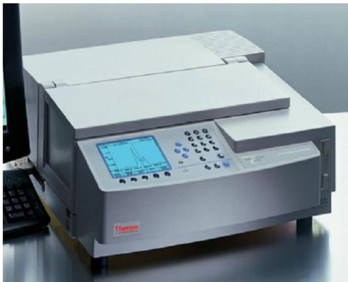
**Figura 5b:** Strumento che misura l'assorbimento luminoso e permette di quantificare gli acidi nucleici.
