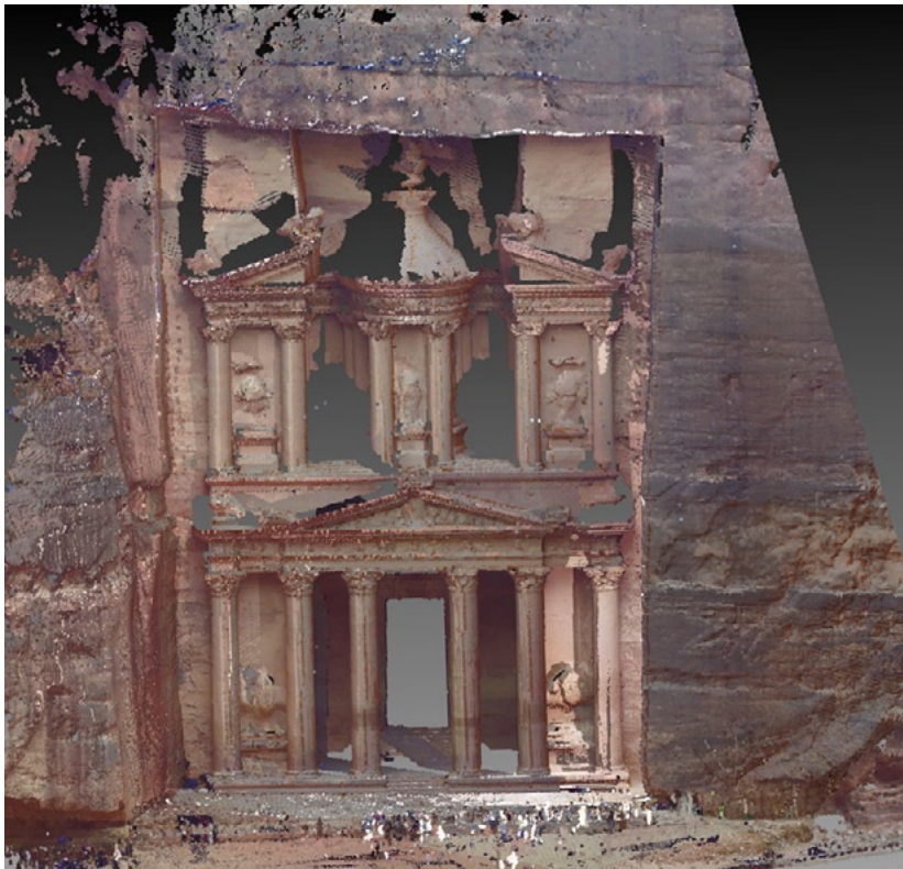
Fig. 2 – Registrazione di diverse nuvole con contenuto colorimetrico prese in diverse ore del giorno da diverse posizioni della stessa area monumentale. L'effetto finale della nuvola colorata sminuisce la bellezza del modello ottenuto (Petra, al-Khazneh o "Tomba del Tesoro").
