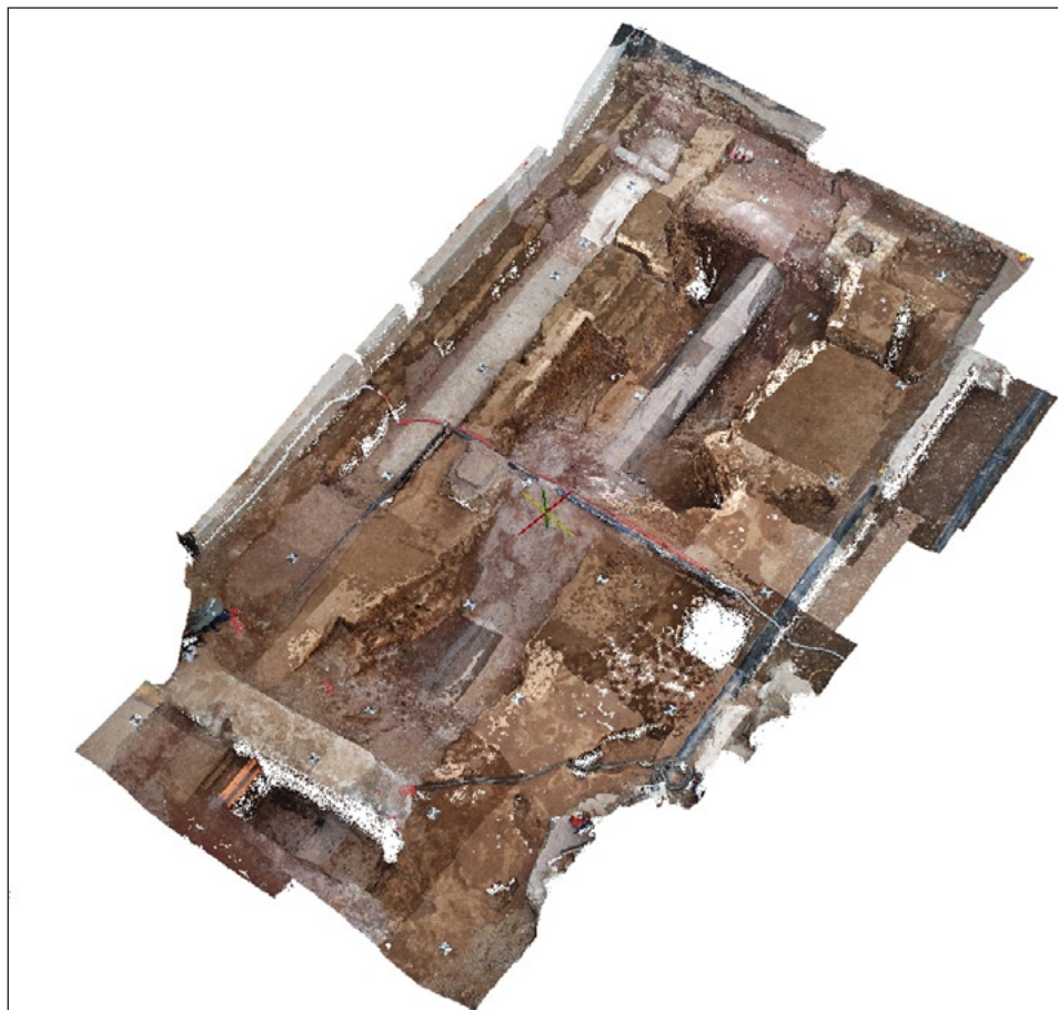
Fig. 5 – Modello numerico a nuvola di punti di una parte dello scavo.
