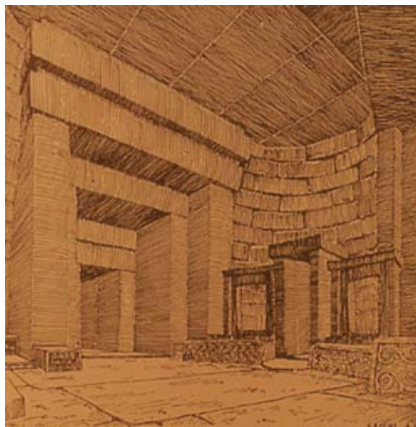
Fig. 10 - Ricostruzione ideale di interno del Tempio megalitico preistorico maltese di Mnajdra, la cui volta è completata da lastre litiche (Ceschi, 1939) Fig. 10 - Restoration of an interior of the prehistoric megalithic Temple of Mnajdra, the vault of which is completed with lithic slabs (C. Ceschi, 1939)
