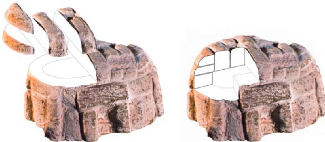
Fig. 11 - Interpretazione delle caratteristiche strutturali e costruttive modellino di Ta Hagraat. Esploso, Sezione (Tampone, 2009, con Derinaldis)
