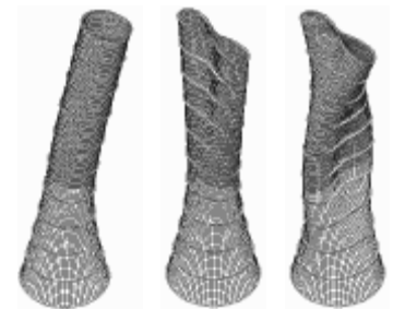
Fig. 4 - Modi di vibrare della struttura con dieci anelli di irrigidimento. Il parametro "n" indica il "numero di onde" che ovalizzano la sezione trasversale.
