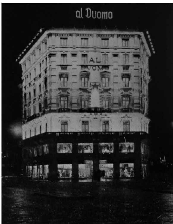
Fig. 8 - L’edificio dei Magazzini “al Duomo” a Milano. L’illuminazione è resa coreografica dal contrasto di luminanze fra il piano dei negozi ed i superiori, illuminati a luce radente dalla balaustra. Le vetrine incastonate nell’architettura scura, danno un effetto in negativo dell’effetto diurno (E. Castaldi, L’illuminazione con proiettori , “Illuminotecnica”, n. 4, aprile 1930, p. 30)
