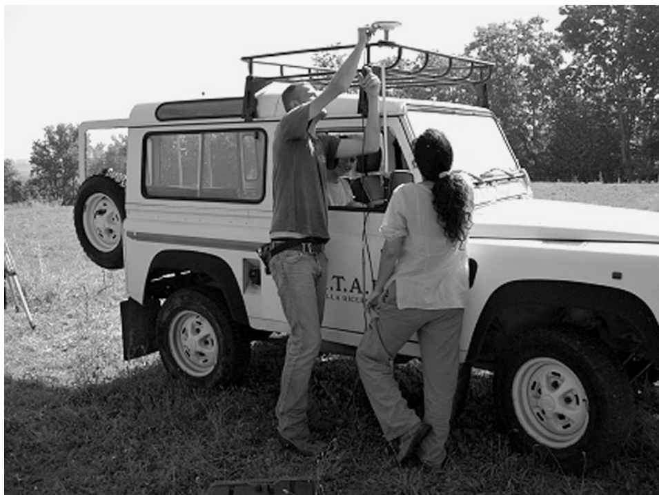
Fig. 3 – L'antenna rover del DGPS montata su Land Rover.
