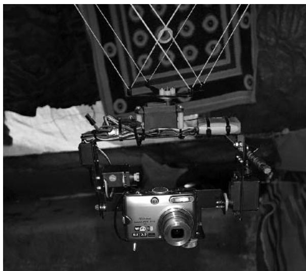
Fig. 9 – Il dispositivo Picavet.
