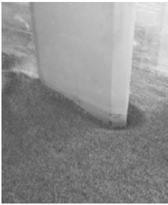
Fig. 4 - Scavo al piede della pila rettangolare con rostri triangolari (prima prova): vista laterale.
