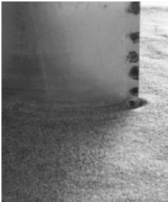
Fig. 6 - Scavo al piede della pila con profilo di Fuhrmann (terza prova): vista laterale. Con la presente foto si riesce ad apprezzare il limitato scavo a monte al piede della pila.
