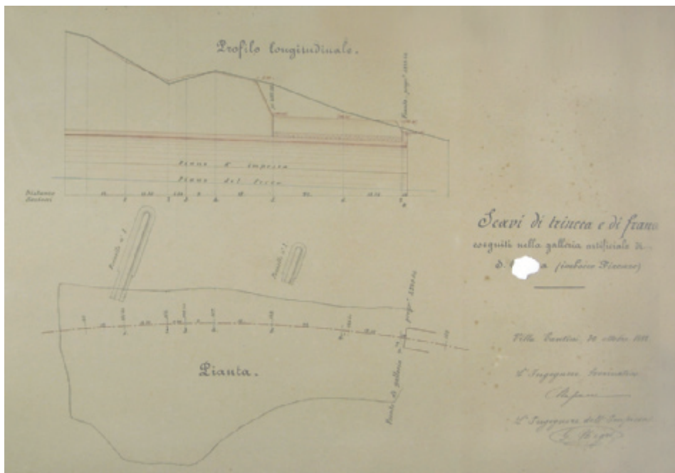
Figura 4 - Porzione del profilo longitudinale e del tracciato della galleria di S. Andrea a Sveglia alla progressiva chilometrica 4+239. La presenza dei contrafforti – pennelli – sul versante del monte conferma la cedevolezza del terreno. La frana interessa 35 metri di galleria, risparmiando i primi 3 metri dall'imbocco Firenze. (ABG, senza inventario)
