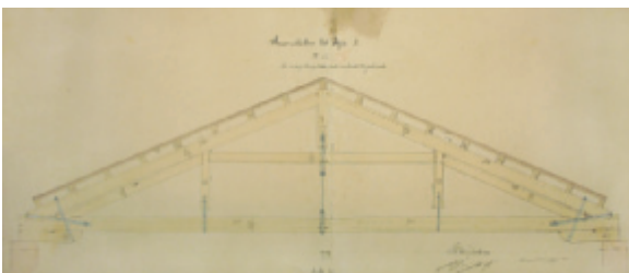
Figura 3 - Disegno per una capriata in legno per la copertura di locali accessori della Fabbrica d'Armi. (ABG, senza inventario)
