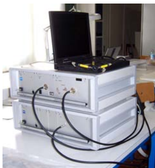
Figura 2. Spettroanalizzatori Zeiss MCS501 e MCS511 NIR 1.7 utilizzati per le misure FORS.
