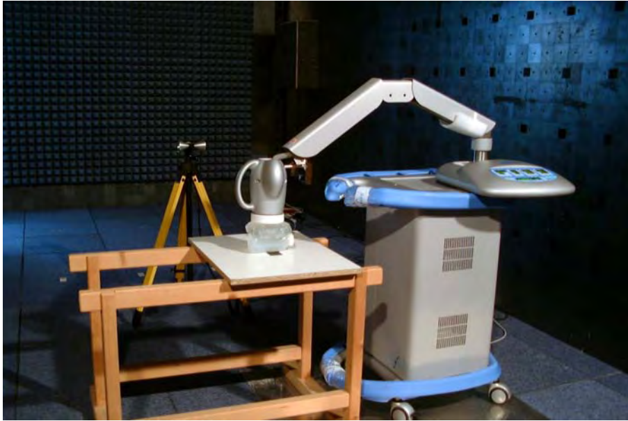
Figura 2 – Set-up di misura per la verifica dell'emissione di campo elettromagnetico dell'apparato
