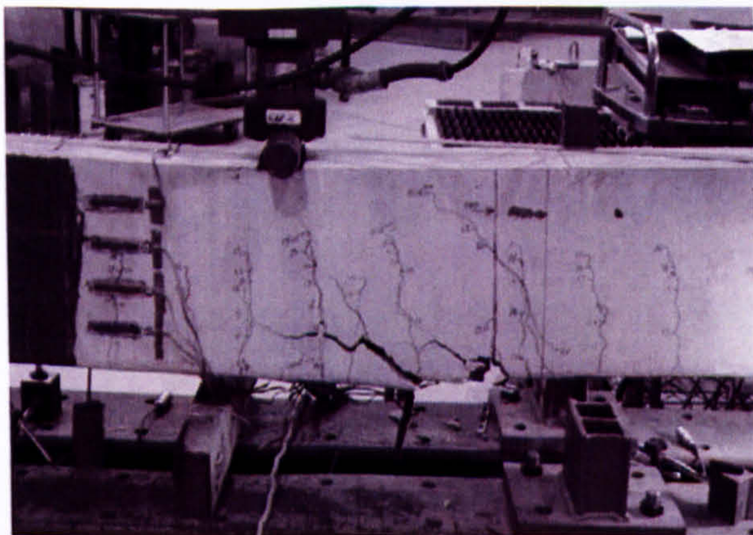
(d) Separation mode II of concrete cover
