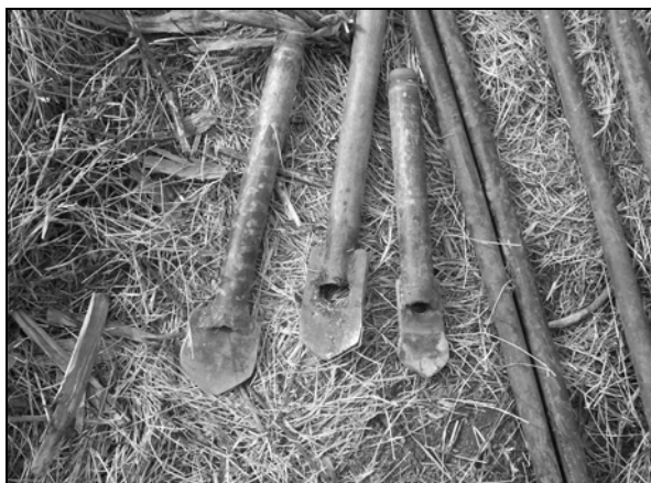
Figura 18: pretérito instrumental, aún utilizado en la perforación de pozos
