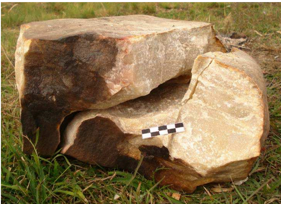
Figura 26. Bloque experimental nro. 2 fracturado por shock térmico.
