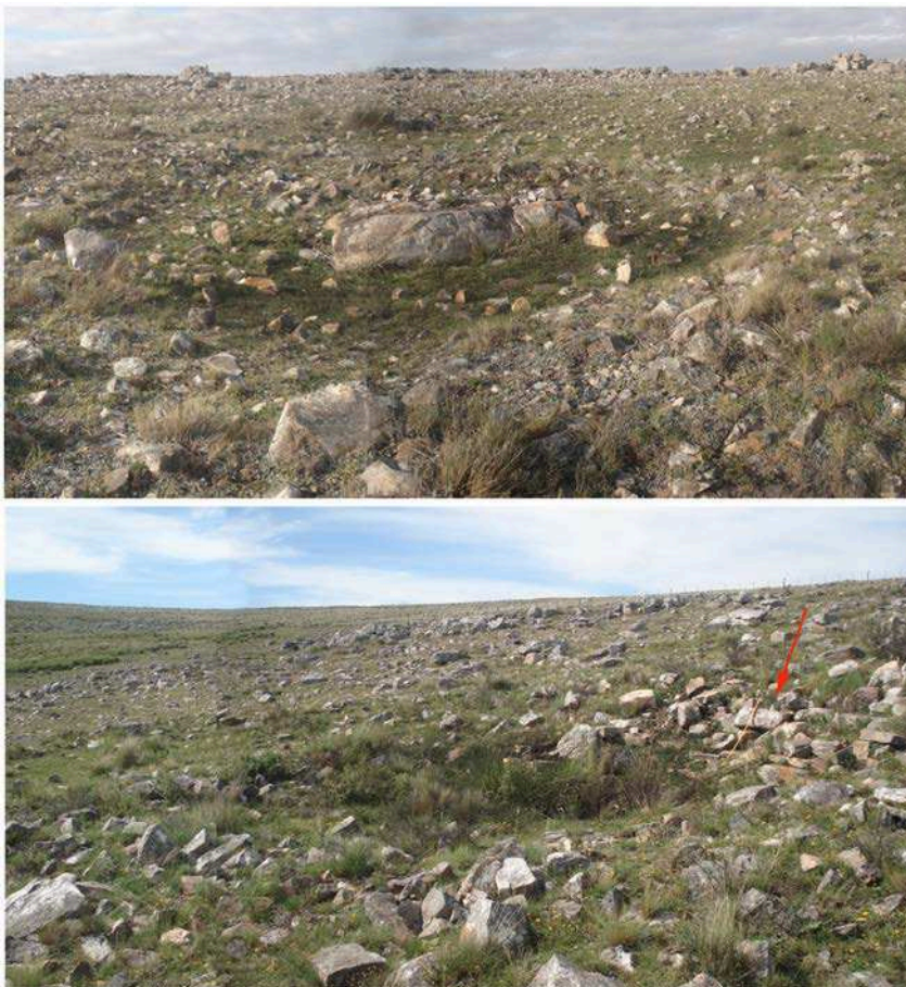
Figura 56. Dos ejemplos de pozos realizados con el fin de ampliar la superficie de explotación de un filón. En ambos pueden verse los remanentes de las masas de roca canteadas.
