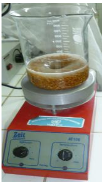
Fig.9 Peleteado de la semilla de trigo con cepas de Trichoderma spp.
