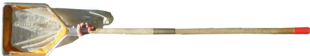
Figura 7: Red tipo Kicknet de 20 cm 2 de área, 250 μm de tamaño de poro y con un mango de 1m de largo.
