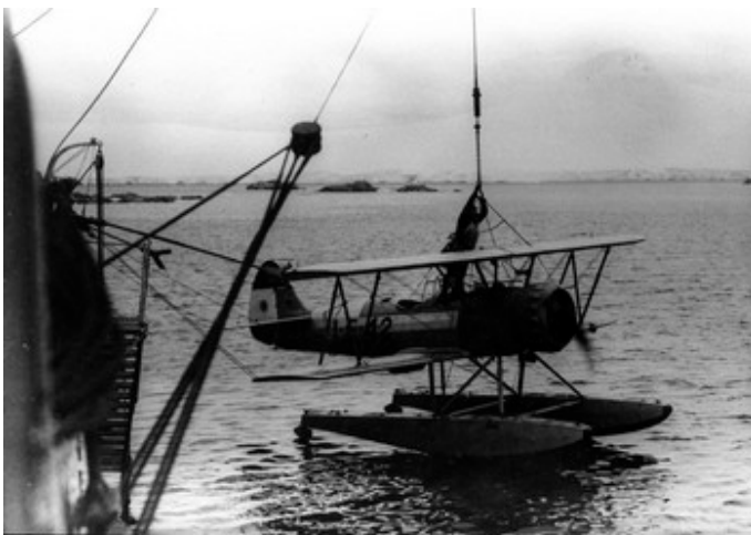
Instante antes de ser colocado el avión en el agua, para efectuar un vuelo de exploración. El acompañante, Tte. Robbio, listo para desenganchar. Obsérvese las drizas y botalones con que es ayudada la maniobra. Puerto Lockroy.
