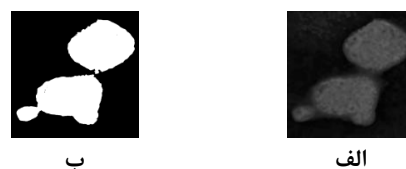
شکل ۹: الف) تصویر پس از اعمال ماتریس و سرکوب غیر حداکثری (ب) تصویر پس از آستانه‌گیری
