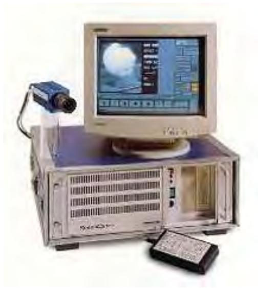
Abb. 2.1: Weinberger Speedcam 500 Highspeed-Kamerasystem der Universität Konstanz ( http://www.weinberger-service.com/d/speedcam.html )
