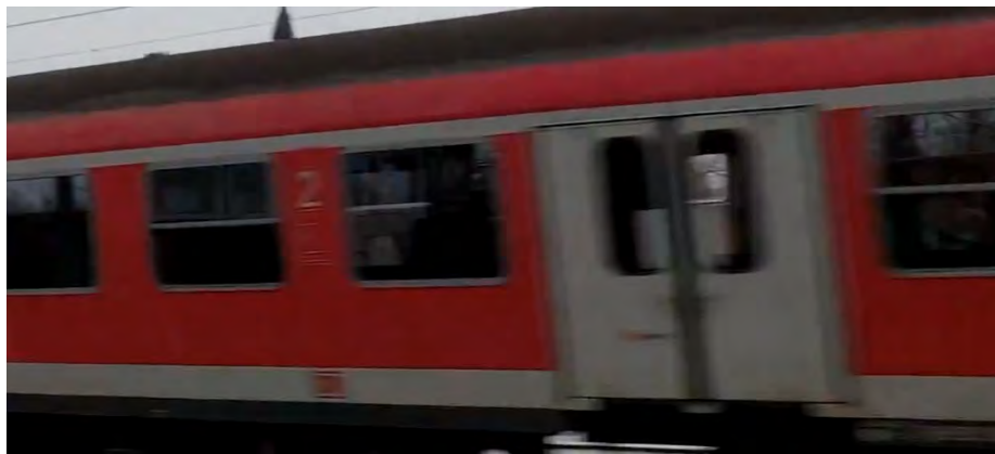
Abb. 3.7: Rolling-Shutter-Effekt bei Aufnahme einer Zugvorbeifahrt: Verzerrung schnell bewegender Objekte durch zeitlich versetztes Belichten der einzelnen Sensorpixel (Zeitversatz von oben nach unten)
