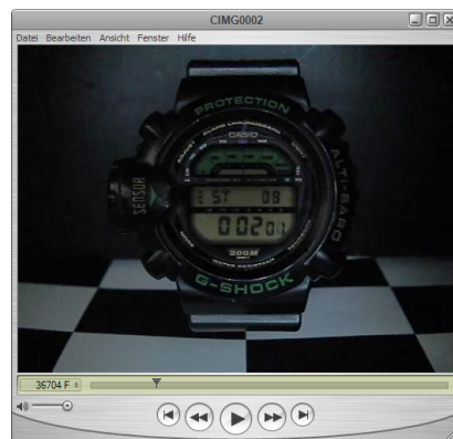
Abb. 4.10: Setup zur Bestimmung der Bildrate: Auslesezeitpunkt 00:02:01, links unten die Frame- nummer des Videobildes (36704 Frames)
