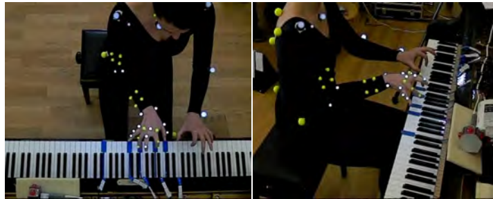
Abb. 4.18: Hybrides Markerset aus Farbmarkern und retroreflektierenden Markern für eine Studie zum Klavierspielen (Riehle, 2012)
