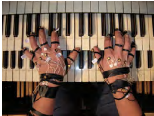
Abb. 2.2: Aktive Infrarotmarker des Lukotronic-Systems der Universität Konstanz zur Bewegungserfassung der Phalange beim Klavierspiel (Riehle, 2009)
