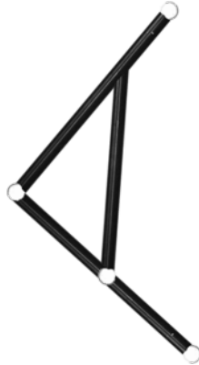
Abb. 4.30: Angepasstes Kalibrierobjekt für die Maßstabsbestimmung und Orientierung des Laborkoordinatensystems zur Kalibration nach Svoboda, Martinec und Pajdla (2005)
