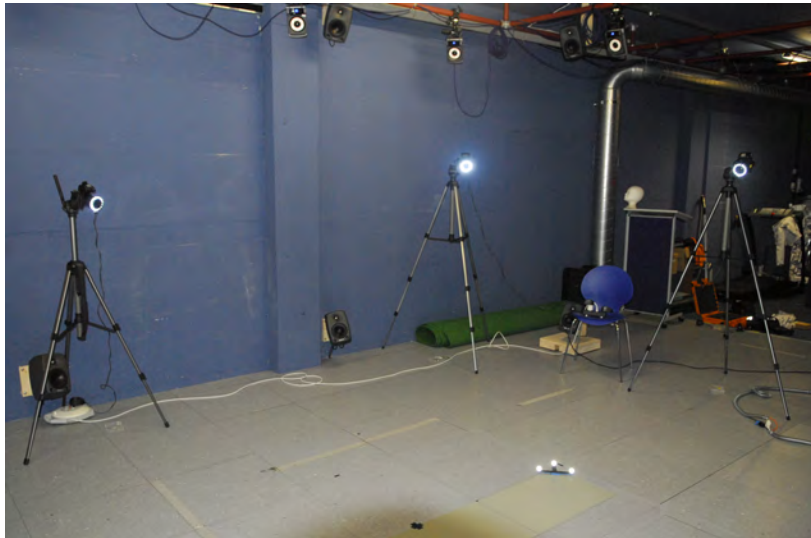
Abb. 4.32: System-Validierungsmessung mit VICON: Die überlappenden Messvolumen erlauben die zeitgleiche Aufzeichnung retroreflektierender Marker mit beiden Bewegungserfassungssystemen.
