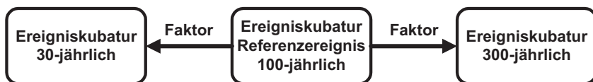
Abb6: Herleitung der Feststofflieferung von 30- und 300-jährlichen Ereignissen basierend auf 100-jährlichen Referenzereignis und mittels Faktoren
