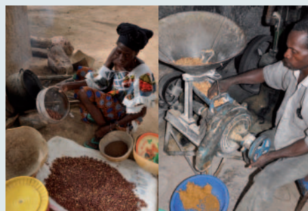
Préparation de la pâte d'arachide : les arachides sont grillées avant d'être transformées en pâte au moulin
